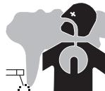
Rook, dampen, gassen en stof die worden uitgestoten tijdens het lassen zijn gevaarlijk voor de gezondheid. Er moet altijd voldoende ventilatie zijn, en soms is de toevoer van frisse lucht noodzakelijk. Een lashelm met verse lucht-aanvoer kan een oplossing zijn als er onvoldoende ventilatie is.
