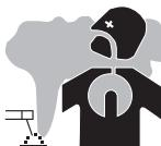
I fumi, i gas e le polveri emessi dalla saldatura sono pericolosi per la salute. È necessario garantire una ventilazione sufficiente e a volte è necessaria un'alimentazione d'aria. Una maschera ad aria fresca può essere una soluzione se la ventilazione è inadeguata. Controllare che il sistema di aspirazione sia efficace, verificando che sia conforme agli standard di sicurezza.
