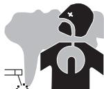
Die beim Schweißen entstehenden Rauchgase, Gase und Stäube sind gesundheitsschädlich. Es ist auf eine ausreichende Belüftung zu achten, manchmal ist eine Luftzufuhr erforderlich. Eine Frischluftmaske kann eine Lösung sein, wenn die Belüftung nicht ausreicht. Stellen Sie sicher, dass die Absaugung wirksam ist, indem Sie sie anhand der Sicherheitsnormen überprüfen.
