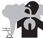
Los humos, gases y polvos emitidos por la soldadura son peligrosos para la salud. Debe proporcionarse una ventilación suficiente, y a veces es necesario un suministro de aire. Una máscara de aire fresco puede ser una solución si la ventilación es inadecuada. Compruebe que el sistema de extracción es eficaz verificándolo con las normas de seguridad.
