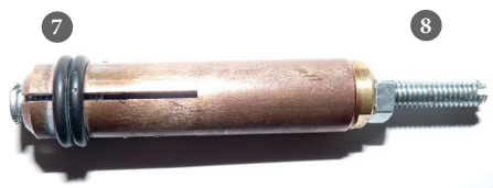
4-gniazdowy miedziany grot do lutowania kołków M4 i M6 (średnica Ø 4 mm)
