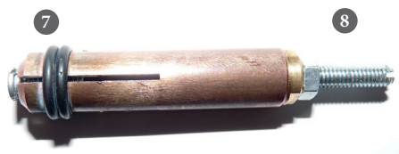
Punta in rame a 4 scanalature per saldare prigionieri M4 e M6 (diametro Ø 4 mm)
