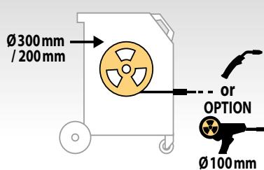
**Uppgraderingsbar** - M1 GYS AUTO kan utrustas med en spolepistol. Detta motoriserat flicklampa är lämplig för ø100 mm trådrullar av aluminium, rostfritt stål, koppar och stål i ø0,8 mm.
