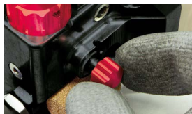
Justering av nitens sätthastighet
