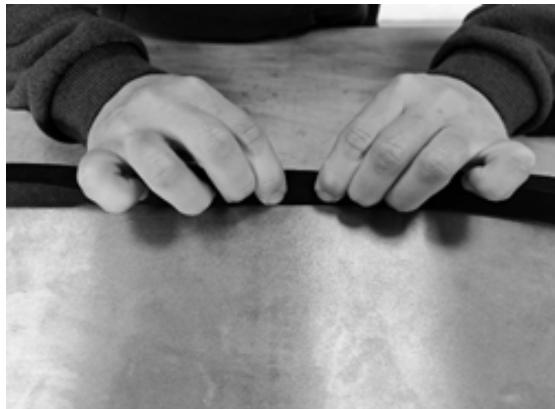
Vérifier que le joint est correctement inséré dans la rainure.
