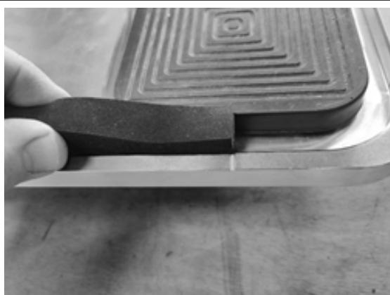
Pincer le joint pour le mettre en place dans la rainure.
