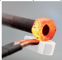
Lossar rostiga skruvar
